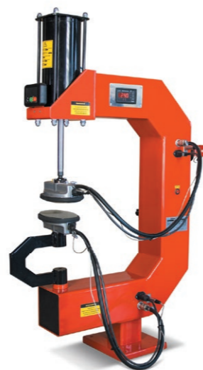
Макси-ТРМ Для ремонта камер и легковых шин до 22 дюймов. 220В, 1230Вт, 150°C
