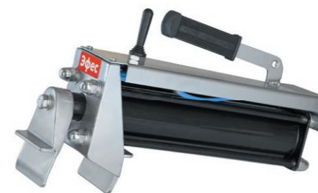
Эфес Пневматический борторасширитель для шин до 22 дюймов.
